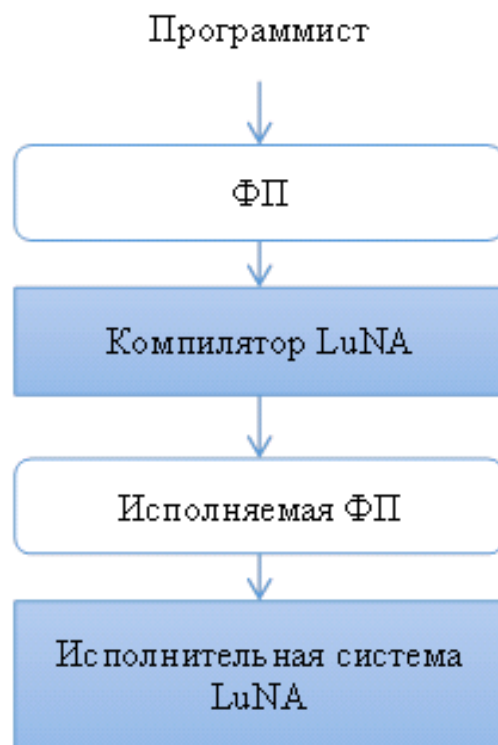
Рисунок 1 – Общая структура системы LuNA (ФП - фрагментированная программа)
