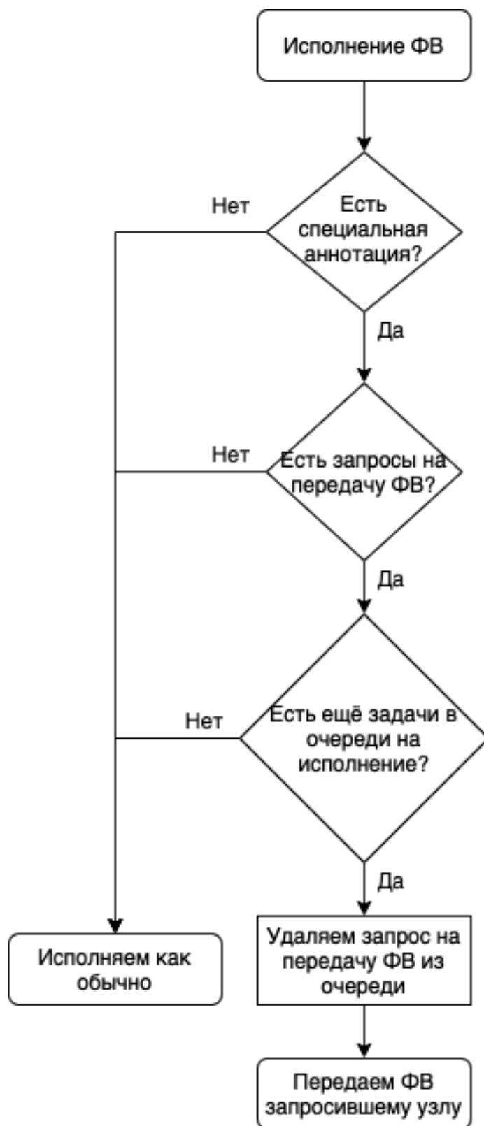
Рисунок 2 – блок схема алгоритма отправки фрагмента
