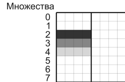
Размещение элементов массивов в кэш-памяти
