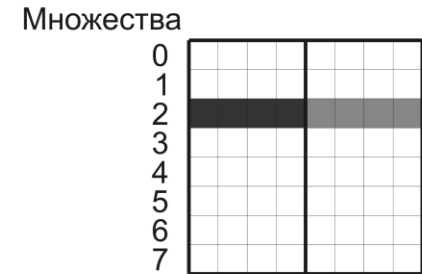
Размещение элементов массивов в кэш-памяти
