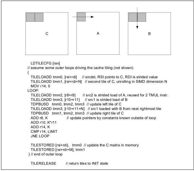
Figure 18-3. Matrix Multiply C+= A\*B
