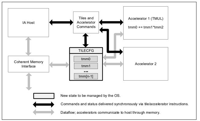
Figure 18-1. Intel<sup>®</sup> AMX Architecture
