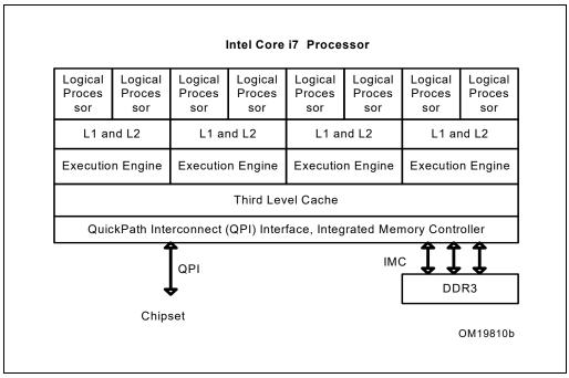
Figure 2-8. Intel<sup>®</sup> Core<sup>™</sup> i7 Processor
