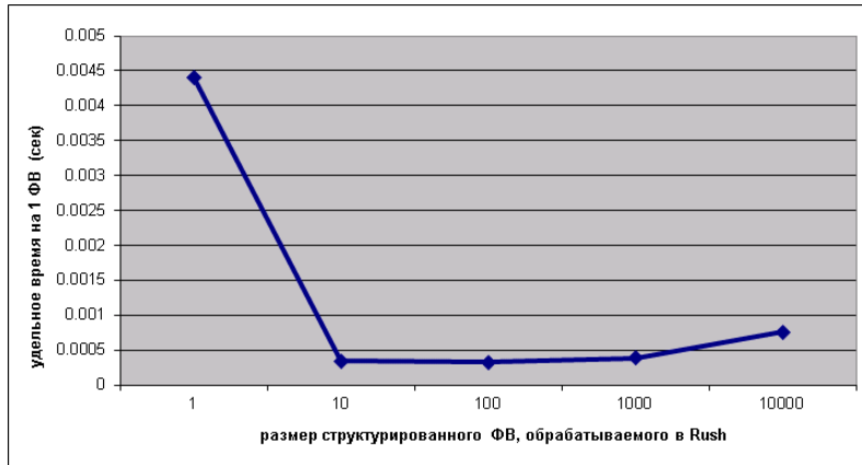
Рис. 5. Зависимость удельного времени работы на вычисление одного ФВ от количества ФВ, обрабатываемых в RuSh. Размер ФД 1 \times 1 \times 1 и 100000 итераций
